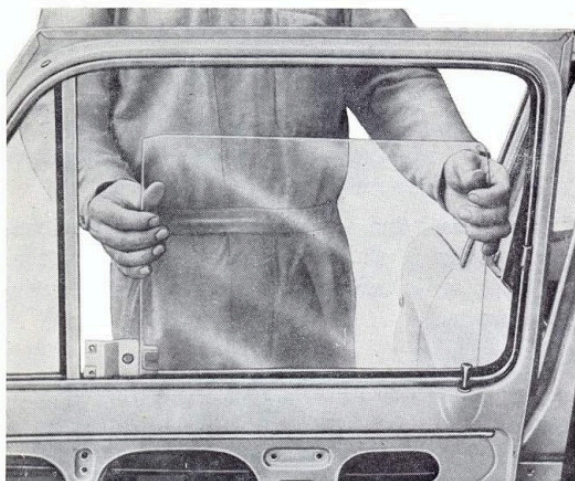
Sl. 46 — Izgrađivanje kliznog stakla zadnjih vrata
