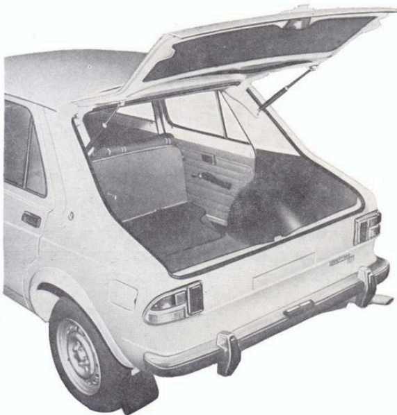
Sl. 59 — Izgled povećanog prtljažnog prostora i položaj oborenog naslona zadnjeg sedišta sa policom
