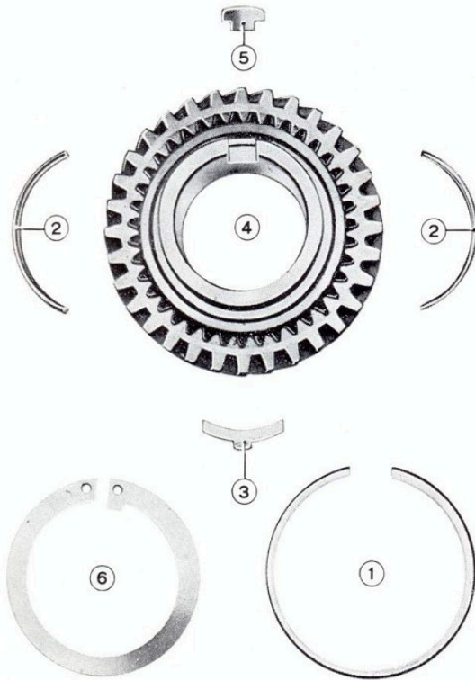
Sl. 18 — Zupčanik 3-eg stepena prenosa i elementi za sinhronizaciju
