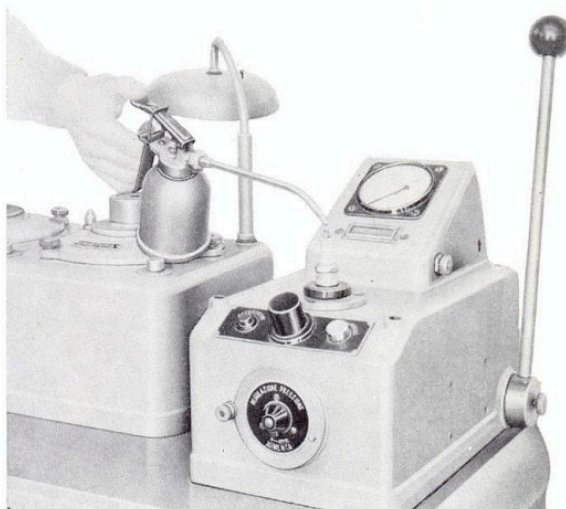
Sl. 10 — Provera unutrašnjeg zaptivanja svećice
